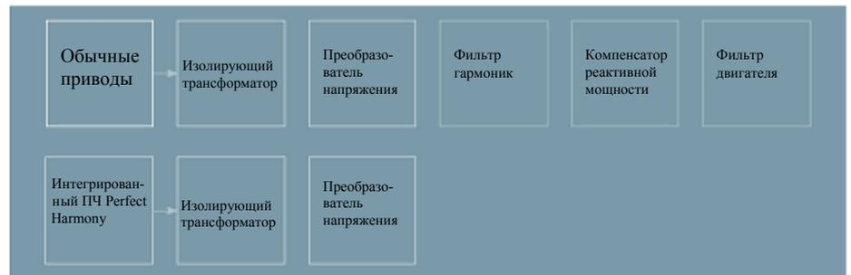
Применение преобразователя частоты Perfect Harmony позволяет добиться значения коэффициента мощности ( $\cos \phi$ ) более 0,95 при нормальных эксплуатационных скоростях без применения дополнительных устройств компенсации реактивной мощности. При этом КПД для преобразователя частоты составит более 98%, а общий КПД для всей системы в целом (включая трансформатор) – от 97% до 96,5%
