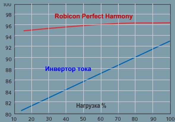
Учтены: КПД согласующего трансформатора, фильтра гармоник, коррекцию по  $\cos \phi$  и самого ПЧ
