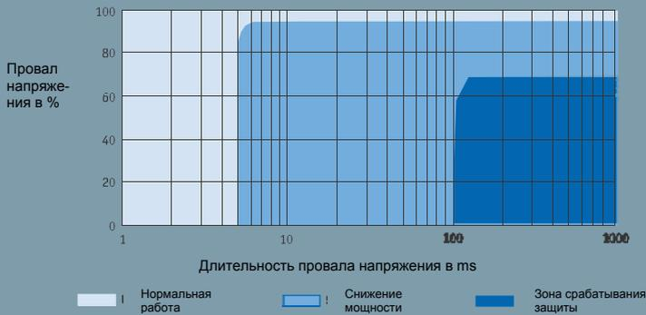
**Устойчивость преобразователя частоты к провалам напряжения при полной нагрузке и номинальном напряжении**
